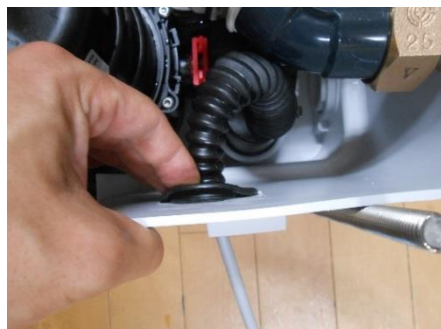
④ 電源コードのゴムフランジを内側から押し込み、フランジの溝を本体にはめ込みます。
