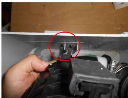
② ガイドレールにポンプアセンブリの固定ガイドを合わせ、装着します。
