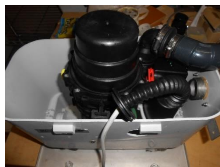
⑤ ポンプアセンブリを引き上げます。
