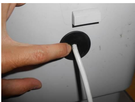
④ 電源コードのゴムフランジをケースの外から内側へ押し込んで外します。
