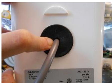
② 電源コードのゴムフランジをケースの外から内側へ押し込んで外します。
