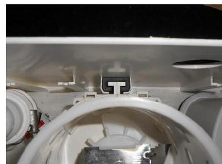
③ A に固定ガイドを合わせ、B にポンプの足をはめ込み、水平に取り付けます。
